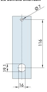
Bei Verwendung des Bohrbildes als Bohrschablone auf angegebene Maße vergrößern.
