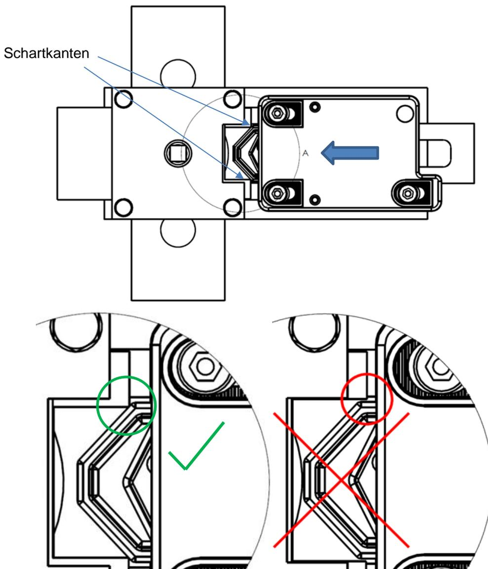
Befestigungsschrauben sind mit einem maximalen Drehmoment von 10 Nm anzuziehen. Um ein selbständiges Lösen der Schrauben zu verhindern, empfehlen wir Schraubensicherungsmittel (kleben).
