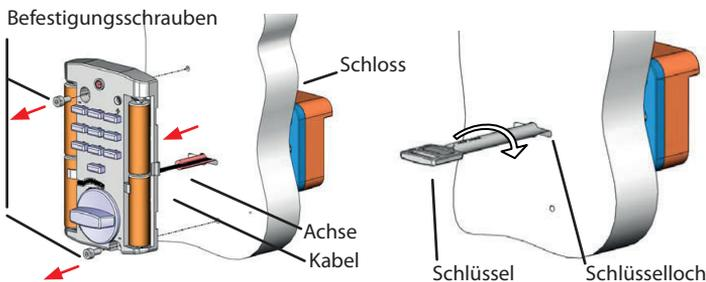
Je nach Montageart wurde das Kabel innerhalb der Achse in den Tresor verlegt (siehe Bild Seite 14) oder durch eine separate Bohrung.
